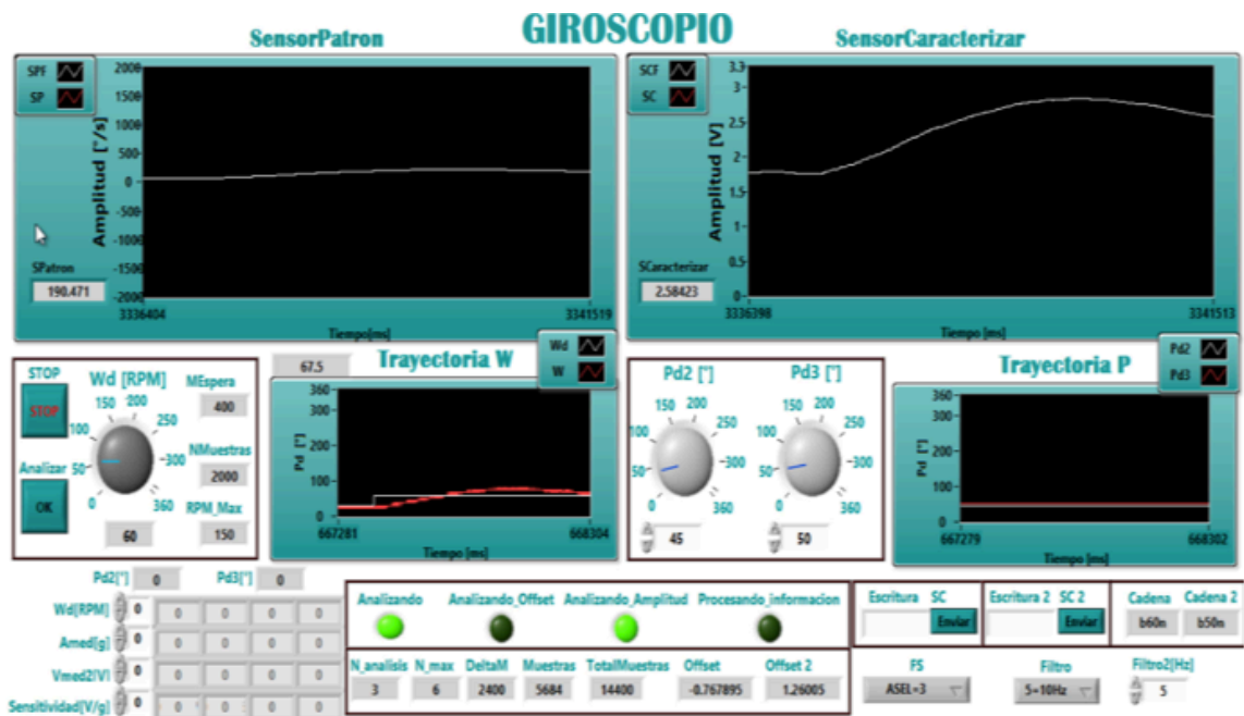
Fig. 5-18 Interfaz gráfica del módulo de giroscopio para probar sensores MEMS.
