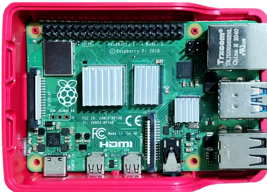
Figura 2.1: Vista superior de la Raspberry Pi 4 modelo B de 8 GB®.
