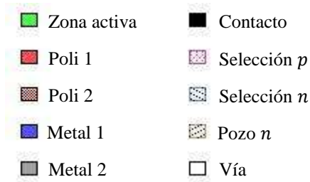
Figura 6.3 Representación gráfica de los materiales que conforman los elementos circuitales en la tecnología de fabricación empleada.
