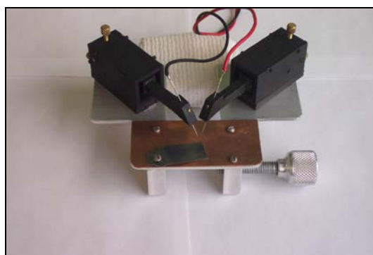
Figura 4.4. Mecanismos ajustables de aluminio, con una estructura de material aislante con puntas de prueba de tungsteno
