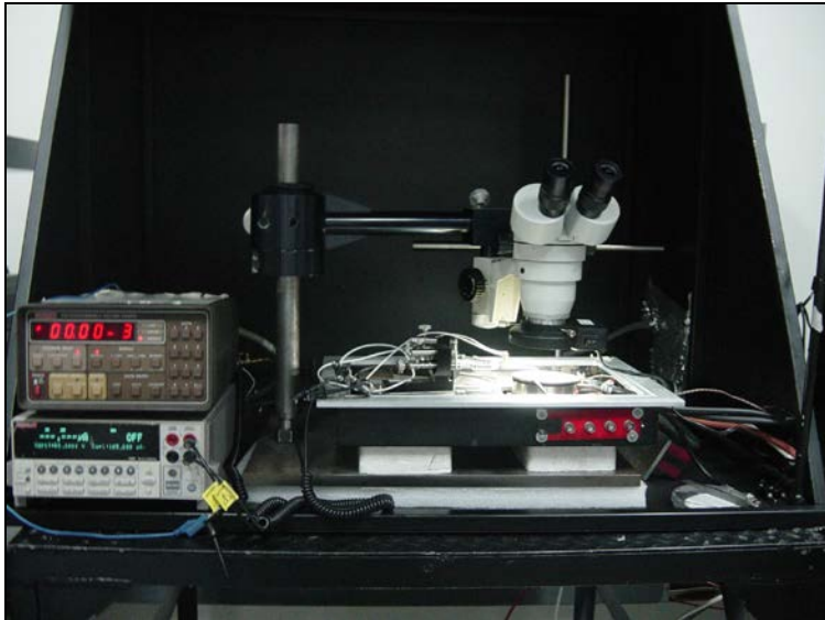
a) Sistema completo de medición con chuck, micropuntas de prueba y aparatos
