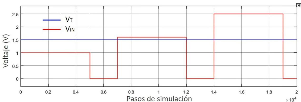
*Figura 4.19* Voltaje de entrada (rojo), comparado con el voltaje de umbral establecido (azul)
