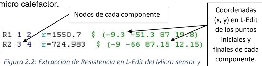
Figura 2.2: Extracción de Resistencia en L-Edit del Micro sensor y Micro calefactor (0.5  $\mu\text{m}$ )
