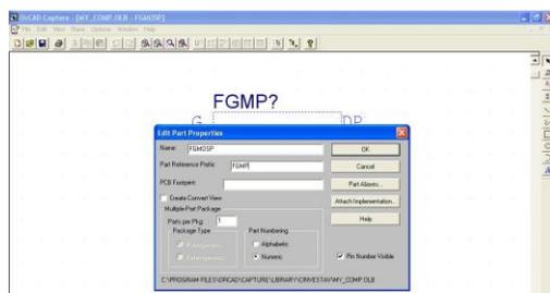
Inicialmente, si nuestro componente tiene parámetros modificables por el usuario, por ejemplo el ancho de canal (W) o la carga inicial en la compuerta flotante (FGI), estos se deben definir como una propiedad, para ello, existe un botón a la derecha de la ventana que dice “New”, una vez presionado aparece una pantalla que pide el nombre y el valor de la propiedad, en el nombre escriba el parámetro, por ejemplo (FGI), la casilla de valor déjela en blanco.
