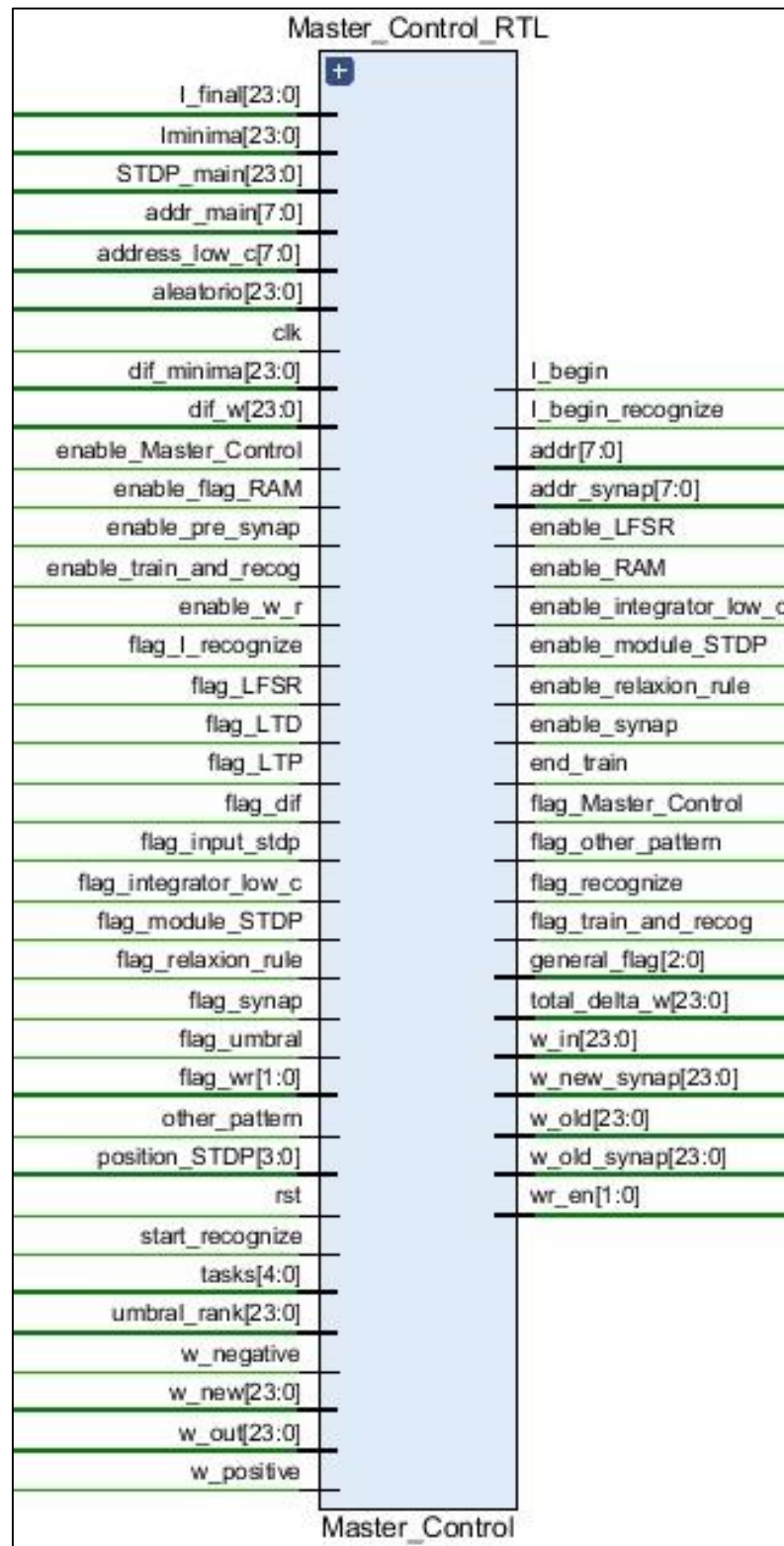
Fig. RTL del módulo "Master_Control". A la derecha se encuentran sus puertos de salida y a la izquierda, los de entrada.
