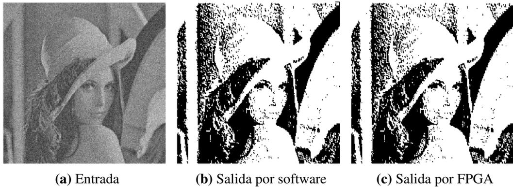
**Fig. 2.11.** Imagen real procesada en software y FPGA para detección de bordes.
