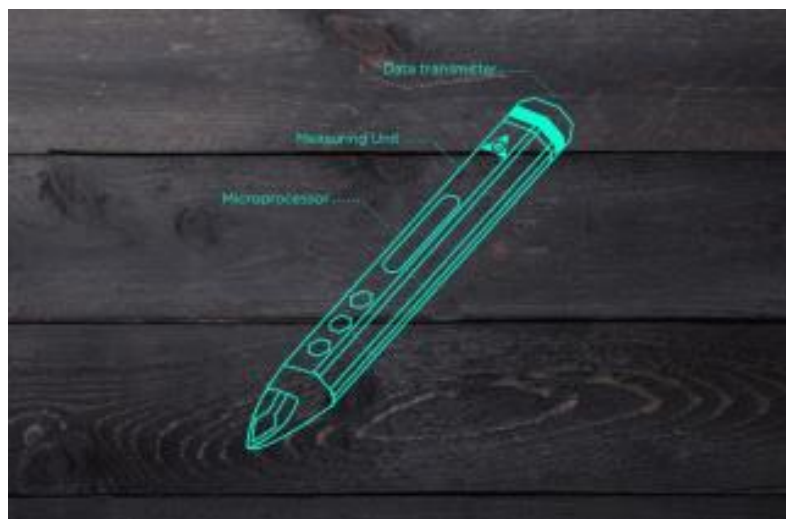
FIGURA 1.3 ELEMENTOS BÁSICOS DEL DISPOSITIVO PARA SU FUNCIONAMIENTO
