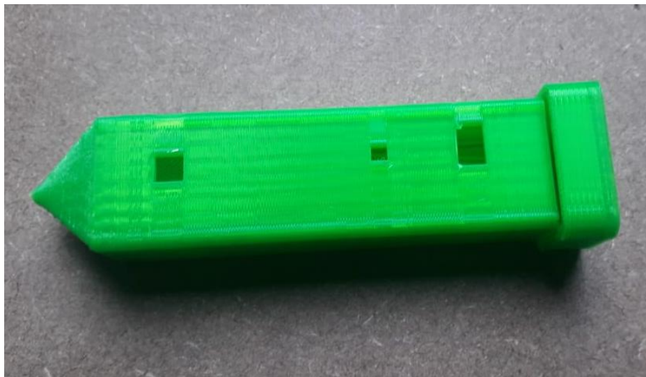
FIGURA 3.32 CUBIERTA DEL DISPOSITIVO IMPRESA
