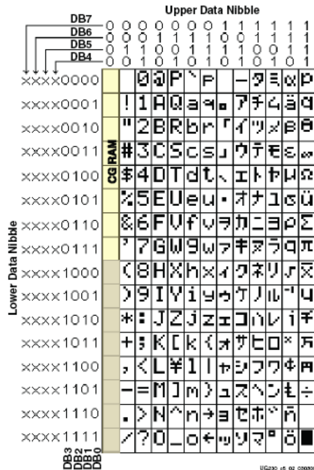
Figura 3. Conjunto de caracteres del LCD
