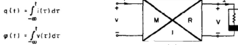
Figura 1.2. Mutador M-R usado en [1] para obtener la característica  $\varphi - q$  de un memristor.
