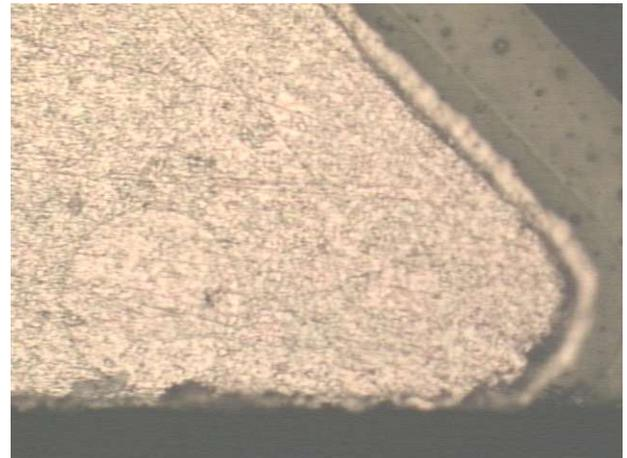
Fig 3.16. magnificación máxima de bajo poder. Se puede ver el corto con más detalle. Esta es el área que se verá a detalle en el SEM antes de pulido.
