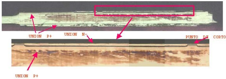
Fig 3.17. Fotos del SEM tomadas a una muestra del grupo T3, gatillo en la esquina.
