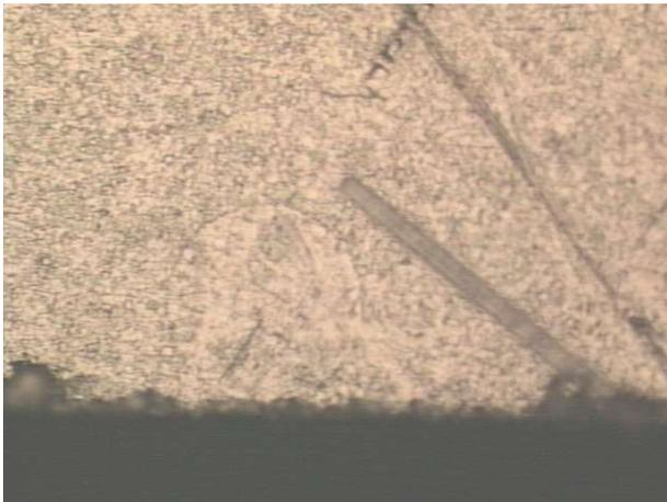
Fig 3.15. Magnificación del área seleccionada. Se puede ver el detalle de un corto en el cátodo. antes de pulido.
