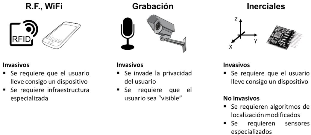
Figura 1-3. Sistemas de localización de objetivos en interiores y sus requerimientos
