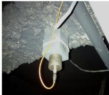
Figura 1-6. Imagen de un acelerómetro sujetado a una viga del edificio Goodwin Hall. Imagen obtenida de [14]
