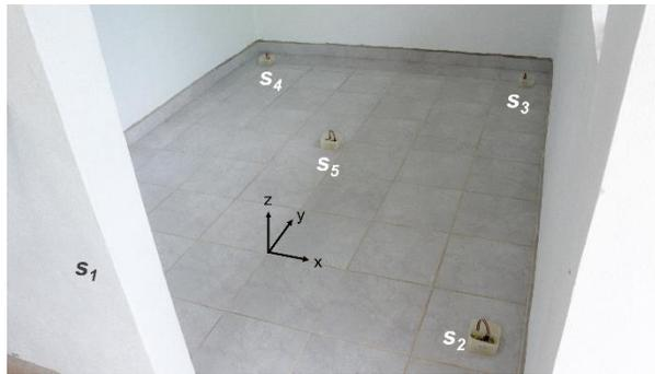
Figura 4-4. Fotografía de la habitación de pruebas. Los sensores se colocan en las ubicaciones no optimizadas
