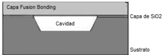
Figura 1. 18.- Unión por fusión de un vidrio con una oblea de silicio mediante una interfaz de SiO<sub>2</sub>.
