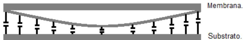
Figura 4. 1.- Integración de capacitancia para la membrana.
